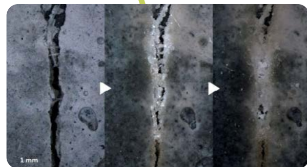
コンクリートの自己治癒プロセス
